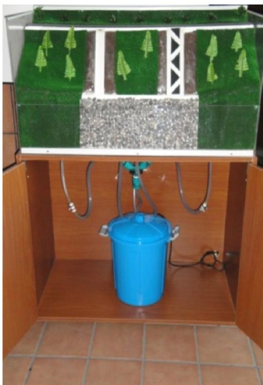
Figura 1. Detalle de depósito, bomba y vista general de la maqueta construida.
