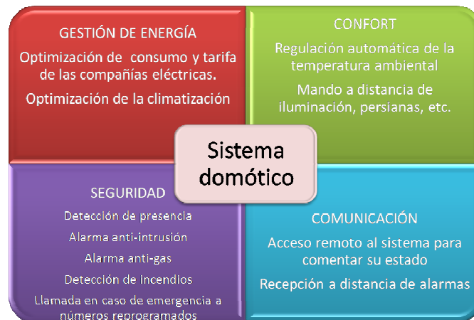
Fig. 1. Funciones principales de un sistema domótico.
