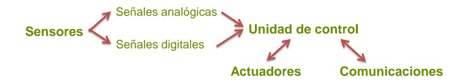
La <u>UNIDAD DE CONTROL</u> centraliza las señales de cada instalación, automatiza su funcionamiento y gobierna las comunicaciones
