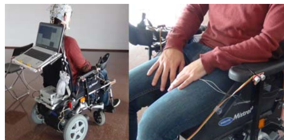
Figura 1: Silla robótica adaptada al control BCI
