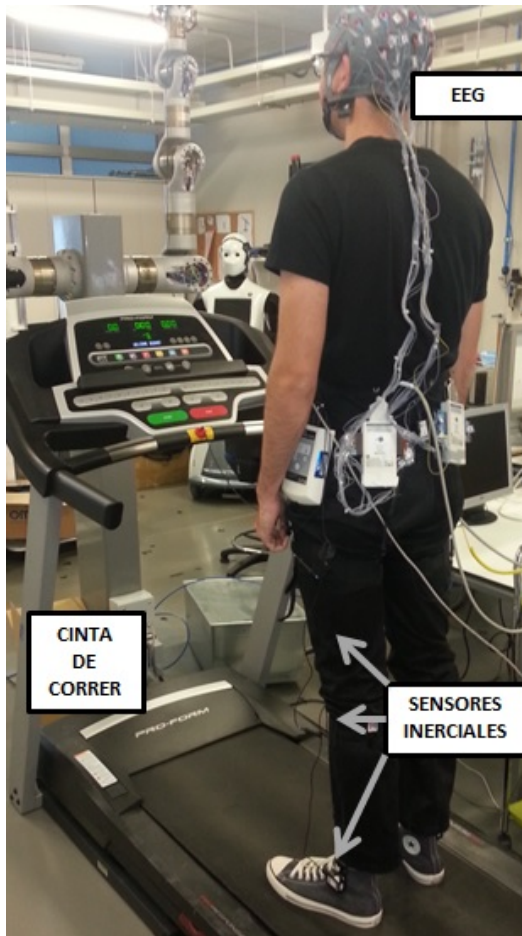
Figura 1: Entorno de pruebas diseñado para el experimento 1 donde el usuario camina a velocidades constantes mientras se miden simultáneamente las señales EEG y los ángulos de las articulaciones.
