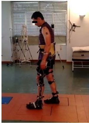
Figura 2: Sujeto sano realizando la prueba de estabilidad de la marcha con exoesqueleto.
