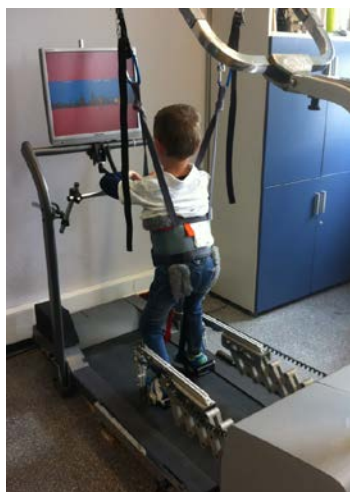
Figura 3: Rehabilitación de la marcha mediante la asistencia de dos brazos robóticos sobre una cinta rodante.
