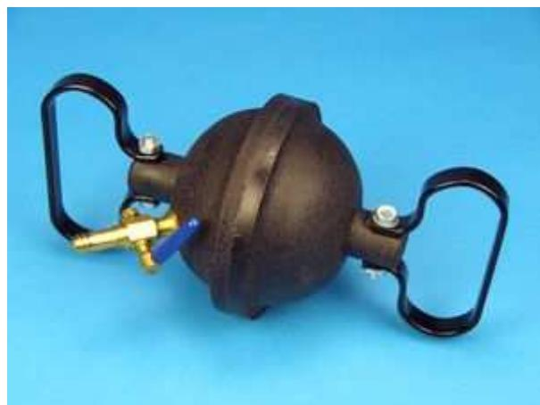
BOMBA DE VACÍO DE MANO Para generar vacío mediante accionamiento manual de una palanca. De plástico, autolubricada (sin mantenimiento) y resistente a la corrosión. Vacío máximo de -940mbar sobre la presión externa. Manómetro en mbar integrado. Boquilla de 7mmØ. Se suministra con manguera y adaptadores a diferentes diámetros. Dim. 270x16x40mm
