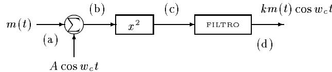
**4-5** Una señal DSB-SC  $m(t) \cos w_c t$  es amplificada antes de ser transmitida. Desgraciadamente, el amplificador tiene una característica no-lineal de amplitud dada por  $e_o(t) = 100e_i(t) + 3e_i^2(t)$ . Suponiendo que el espectro de  $m(t)$  está limitado en banda a  $B$  Hz, trace el espectro de la señal a la salida del amplificador. ¿Es posible recuperar la señal DSB-SC sin distorsión?. En caso afirmativo, indique si existe alguna restricción sobre la frecuencia de portadora  $w_c$ .
