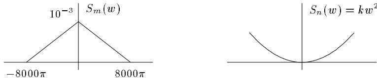
**4-16** Para un receptor DSB-SC síncrono como el mostrado en la figura, la PSD del ruido es constante igual a  $\mathcal{N}/2$  con  $\mathcal{N} = 10^{-7}$ . La PSD de la señal es también constante igual a  $\beta$  en la banda de frecuencias  $|w| \leq 2\pi B$  con  $B=4\text{KHz}$ .
