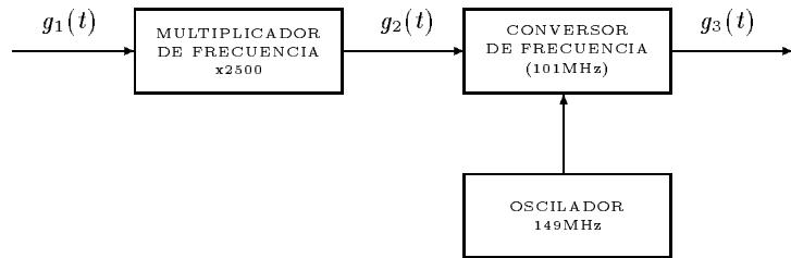
La señal modulante es  $g_1(t) = A \cos[w_c t + k \int m(\tau)d\tau]$  donde  $w_c = 2\pi \times 10^5$ ,  $k = 0.05$ ,  $m_p = 200$  y el ancho de banda de  $m(t)$  es de 100Hz. Calcule la desviación en frecuencia y el ancho de banda de las señales  $g_1(t)$ ,  $g_2(t)$  y  $g_3(t)$ .
