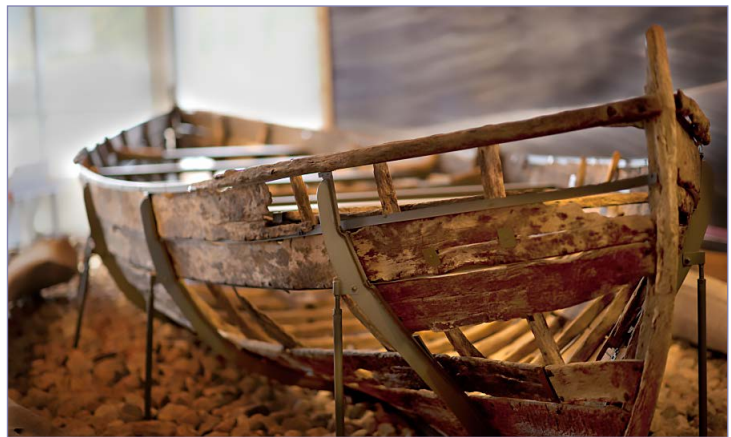
Fig. 10. Chalupa ballenera vasca encontrada junto con el pecio de la nao San Juan hundida también en Red Bay, Canadá en 1565. Su casco presenta las 4 tablas, partiendo de la quilla, juntadas canto con canto y las 2 superiores solapadas. La embarcación está expuesta en el museo de Red Bay National History Site (Imagen extraída de la página web de A Northern Heritage, Research and Arts Organization).
