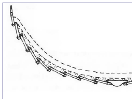
Fig. 6. El casco a tingladillo del pecio de Sutton Hoo, Reino Unido (Imagen extraída de la publicación de Ejstrud, B., A. Hunnicke, T., Husum, C., Korre, A., Maarleveld, T. y Vafeiadou, K., 2008).
