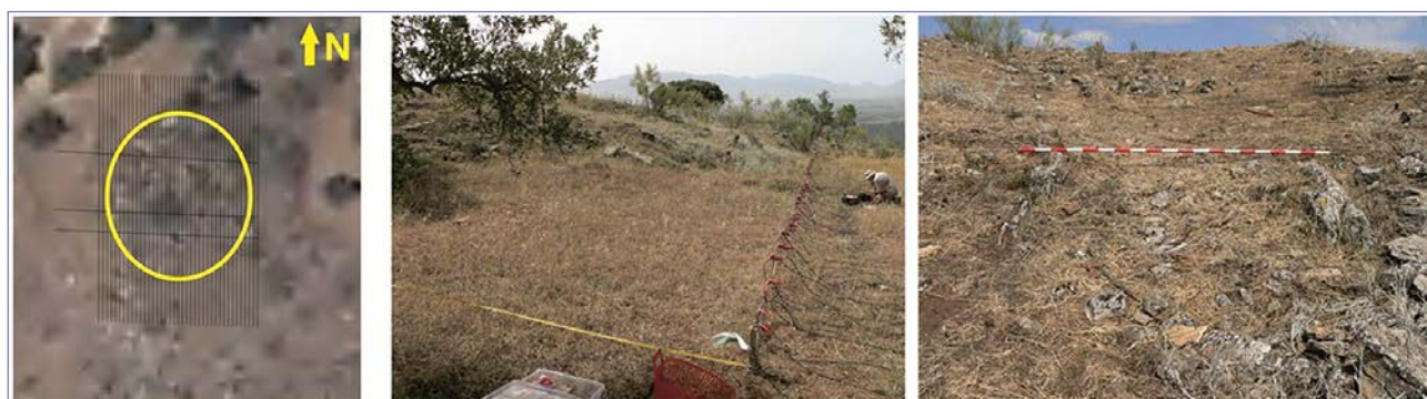
Fig. 3. Emplazamiento de los perfiles eléctricos en la zona de estudio, el círculo amarillo marca la elevación a investigar. (b) Vista general de la adquisición de un perfil eléctrico. Las medidas de resistividad aparente se realizaron con un equipo de tomografía TERRAMETER LS-12 (ABEM; Inc.). (c) En superficie se observan las caras superiores de lo que aparentan ser dos ortostatos paralelos pertenecientes al corredor de acceso, su orientación ha determinado el trazado de los perfiles eléctricos.
