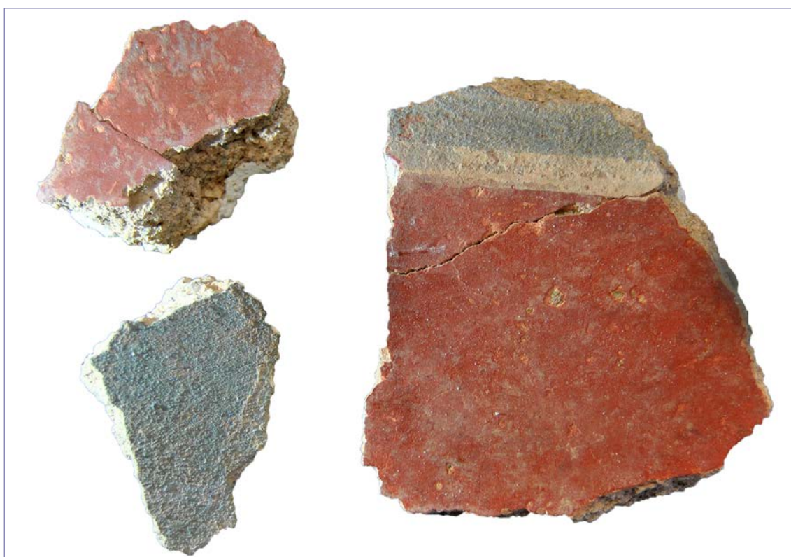
Fig. 6. Diferencias de acabado entre las superficies ejecutadas al fresco y al seco; imagen tomada con luz rasante.
