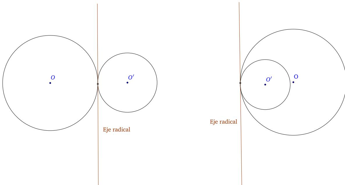
Si las circunferencias son exteriores podemos trazar una tangente común y el punto medio será del eje radical. Trazando la perpendicular a la línea que une los centros por este punto obtendremos el eje radical.
