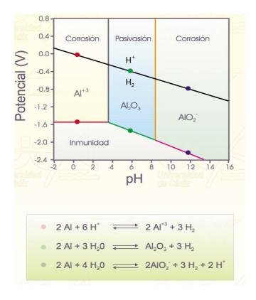
Por supuesto, estos diagramas nos indican también cómo podemos proteger un metal frente a la corrosión. Estos tipos de protección suponen una protección anódica, una protección catódica o una protección por pH desplazándonos hacia pH más elevados para conseguir una pasivación del metal.
