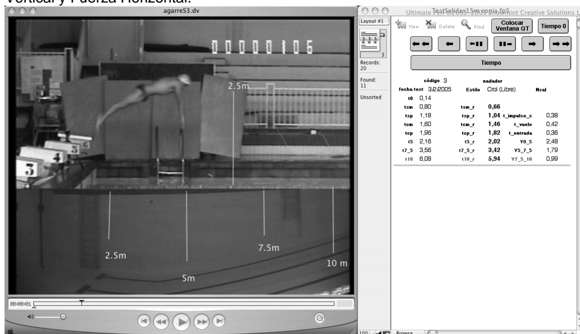
Figura 2: Descripción gráfica del sistema utilizado para recoger el código de tiempo del registro de video digital (formato Quicktime .dv) desde la base de datos (Filemaker 6.0) gracias a botones con scripts pre-programados. El botón más grande inserta el tiempo de campo en que se produce el evento al campo correspondiente, el resto sirve para avanzar el video digital adelante y atras a diferentes velocidades. Las líneas de referencia se encuentran dibujadas en la pantalla sobre el sistema operativo (Mac OS X 10.3.8) usando la aplicación Ultimate Pen™.
