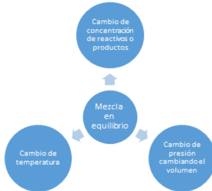
El equilibrio puede verse modificado por diferentes factores. Los más significativos en una reacción donde solo tienen importancia los gases son: a) **una modificación de la concentración de reactivos o productos**, b) **un cambio en la presión total del sistema**, y c) **un cambio en la temperatura**.
