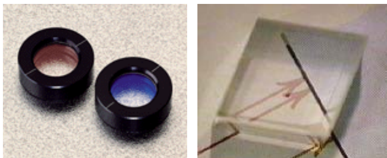
Figura 5.4. Láminas retardadoras (izquierda) y birrefringencia en un cristal de calcita (derecha).
