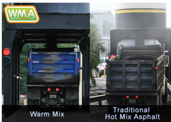
Figura 18 - Diferencia de humos entre una mezclas convencional y otra semicaliente. Fuente: warmmixasphalt.org
