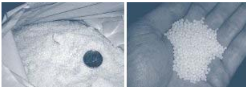
Figura 11 - Sasobit en forma de polvo y granular. Fuente: D'Angelo et al. [16]
