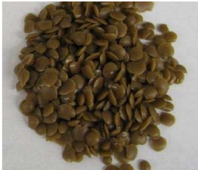
Figura 13 - Rediset y su forma granular/ pastilla. Fuente: RedisetWMX.com
