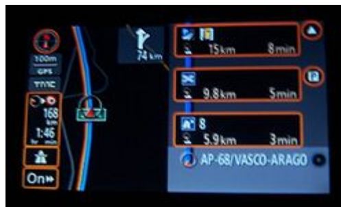
Figura 4. Navegador GPS de pantalla táctil de un vehículo con información sobre la ruta, así como las distancias y tiempos de llegada al punto de destino.
