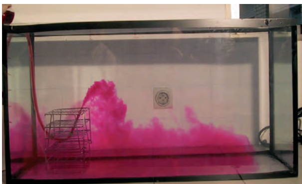
Fig. 1. A. Modelo físico de laboratorio CEPYC (Ruiz Mateo 2007). Simulación del campo cercano de vertido en chorro.
