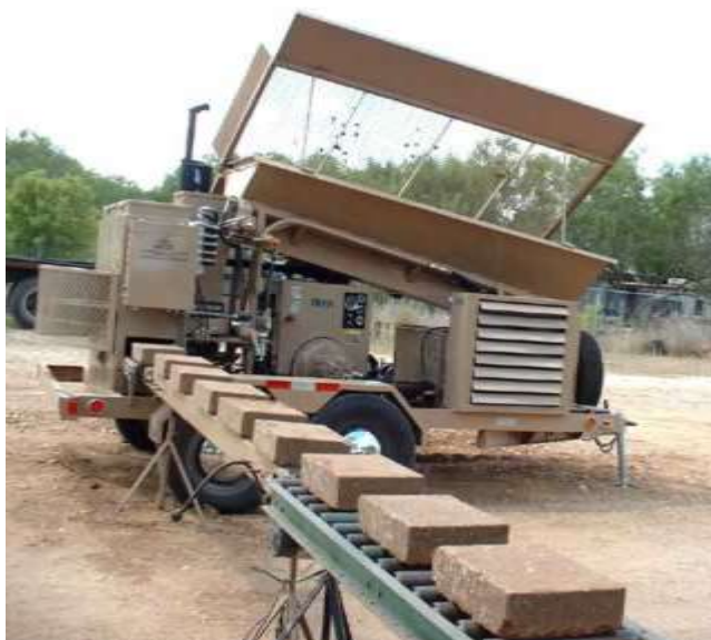
Figura 10. Creación de bloques de tierra comprimida (Fuente: www.http://thenauhaus.com ).
