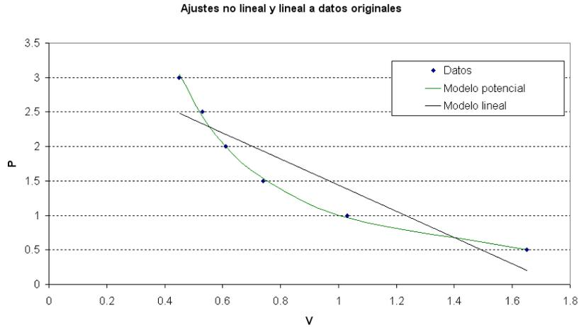
Figura 3: Datos observados de la presión ( $P$ ) y el volumen ( $V$ ) junto con los dos modelos ajustados.
