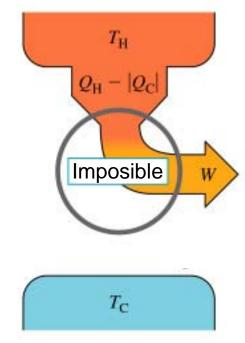
• Supongamos una máquina que extrajera calor  $Q_C$  a temperatura  $T_C$  y se convierta toda en trabajo, W. La 1ª ley permite tal proceso, pero la segunda ley niega la existencia de este ciclo.
