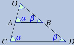
Si por un triángulo se traza una paralela a cualquiera de sus lados, se obtienen dos triángulos semejantes.
