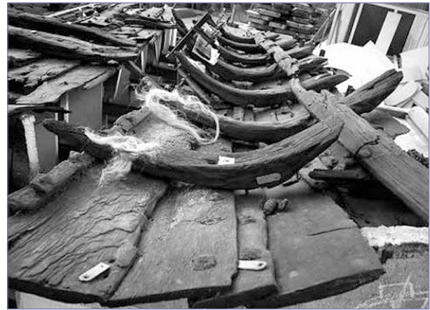
Fig. 1. Casco del pecio de Urbietta, Guernica (Vizcaya), en el que se aprecia el solapamiento de las tablas de madera reforzado con varengas y genoles (Imagen de Izaguirre, M. extraída de la publicación de Rieth, H., 2006).
