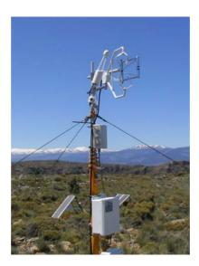
Ejemplo de una torre de eddy covariance instalada en el campo. Más concretamente se trata de la torre EC instalada en el Llano de lo Juanes (Sierra de Gádor, Almería).
