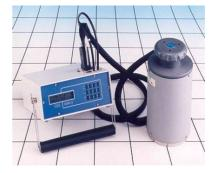
Ejemplo de dos de los sistemas de cámaras para la medida de flujo de CO<sub>2</sub> del suelo: LI-8100 (Li-Cor, Lincoln NE) (izq.) y PP systems EGM-4 & SRC-1 (PP systems, Hitchins, UK) (dcha).
