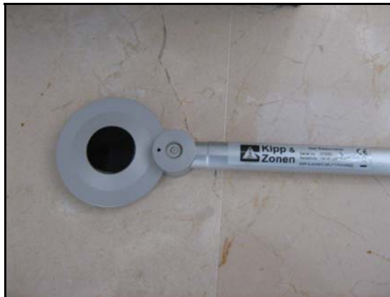
Fig 2.6. Fotografía de un radiómetro neta modelo NR Lite
