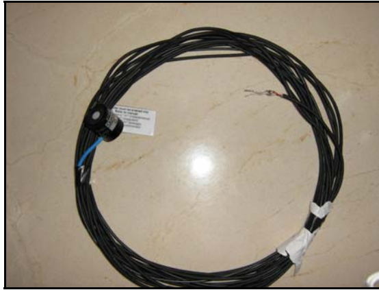
Fig 2.7. Fotografía de un sensor de radiación PAR modelo LI-1900
