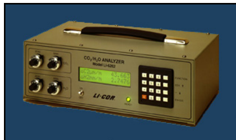
Fig 2.3. Fotografía de un IRGA modelo Li-6262 closed path
