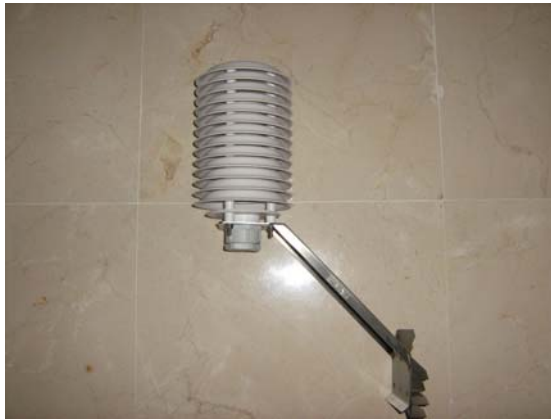
Fig 3.10. Fotografía de un termohigrómetro
