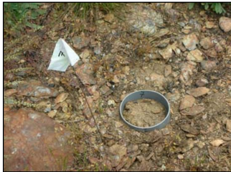
Fig 2.13. Fotografía de uno de los collares para medir respiración de suelo
