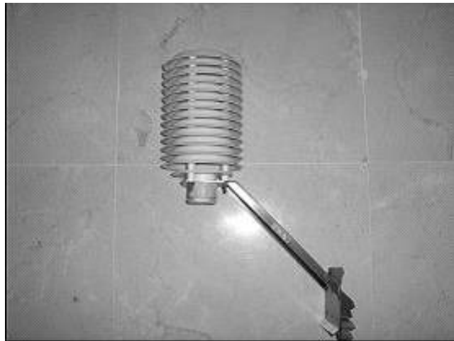
Figura 3.31: Fotografía de un termohigrómetro.
