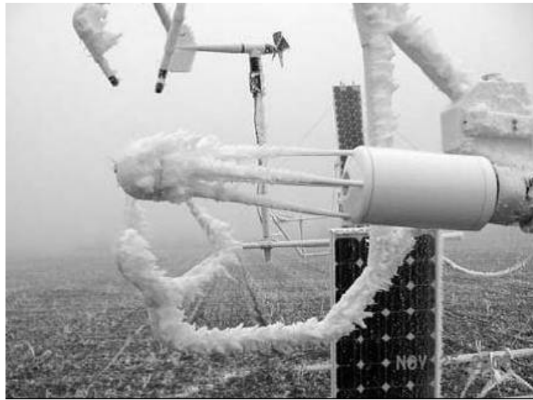
Figura 3.7: Fotografía de un LI-7500 durante un evento de nieve en Noviembre 2005. Nótese que todo el aparataje está congelado salvo la carcasa inferior del open path por efecto de su electrónica [Amiro et al., 2006a].
