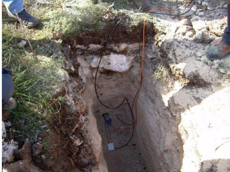
Fig. 2. Ubicación de los sensores en la zanja excavada.
