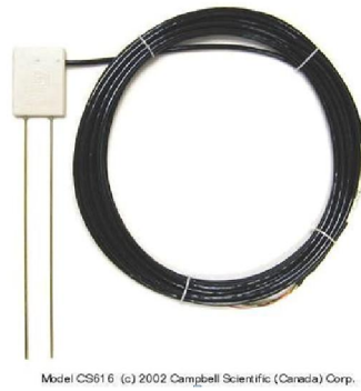
Fig. 6. Sensor de contenido volumétrico de agua CS616 Campbell.
