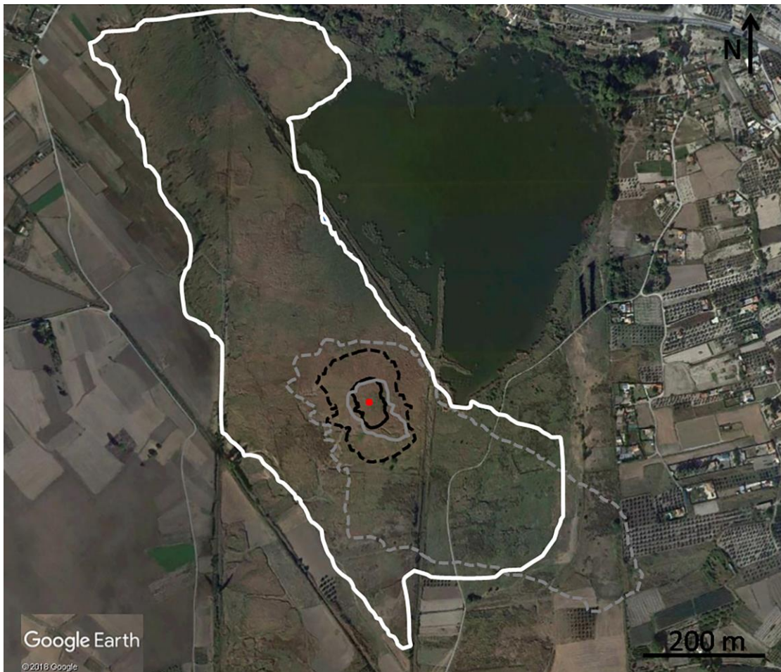
Figura 2. El punto rojo representa la torre de medidas; saliendo de allí en dirección radial, para cualquiera dirección del viento: la línea sólida representa la distancia desde la torre con la máxima aportación al flujo medido (negra durante el día; gris durante la noche); la línea discontinua envuelve la zona con 50% de la contribución al flujo medido (negra durante el día; gris durante la noche); la línea blanca envuelve la zona con Phragmites australis (Serrano-Ortiz et al., 2020).
