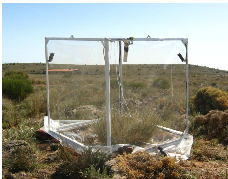
Figura 2. Cámara de cierre transitorio midiendo intercambios de CO 2 entre una planta de Festuca scariossa y la atmósfera en “El Llano de los Juanes”.
