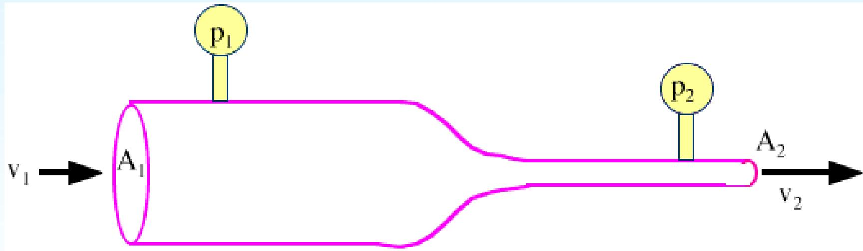
Determinar la velocidad en un tubo, por mediciones de presión
