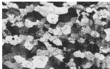
Fig. 9. Fábrica poligonal de granos de escapolita formada por re-cristalización estática. (Passchier y Trouw, 1996).
