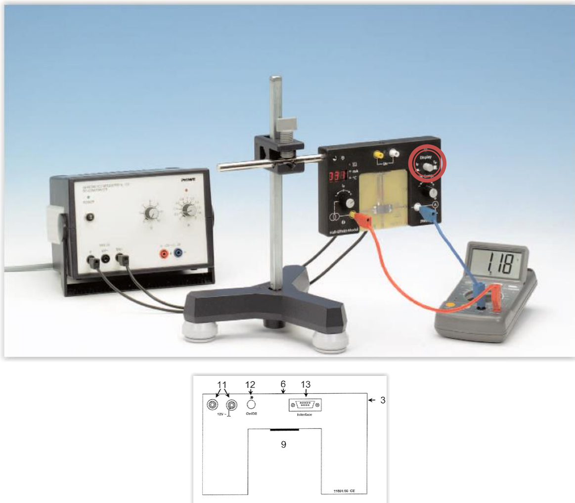
Fig. 1. Placa portadora de Germanio, con sus conexiones.
