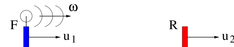
Figura 6.1: Fuente (F) y receptor (R) de un sonido en movimiento respecto al aire.
