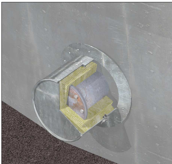
Figura 4: Aislamiento del registro de un tanque.
