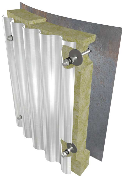
Figura 1a: Aislamiento de la pared de un tanque metálico.
