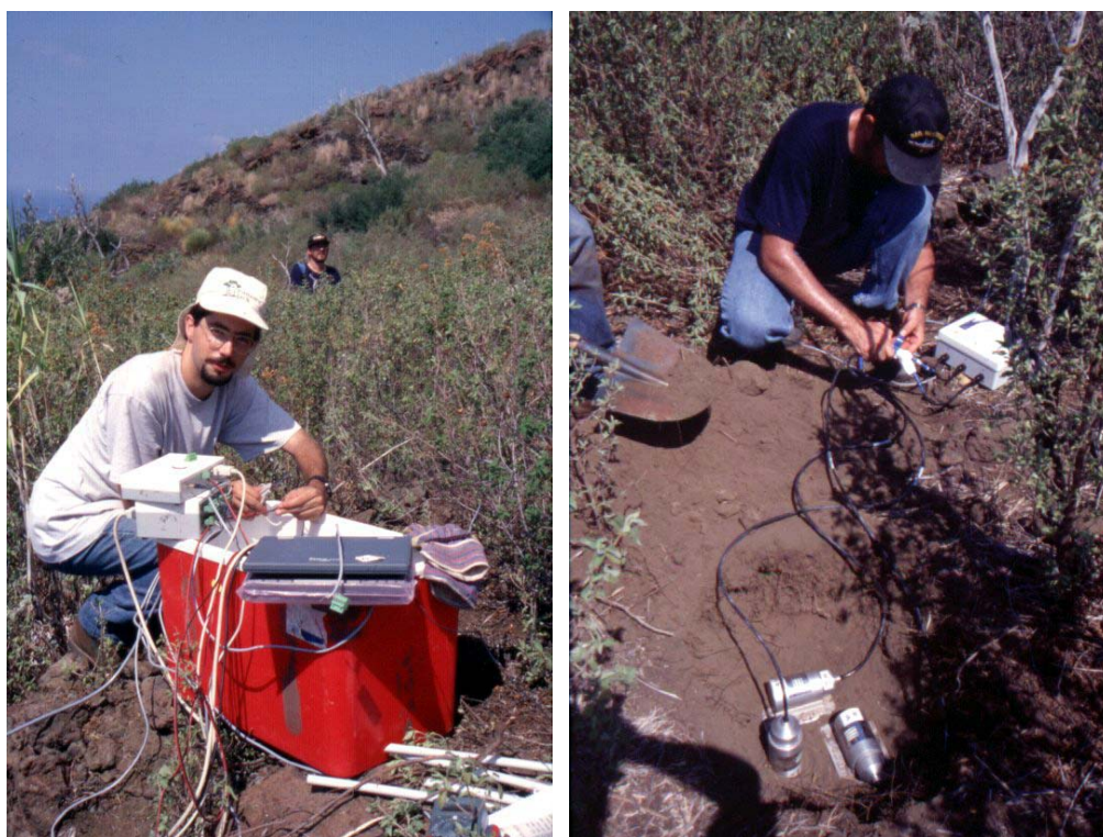
Figura 4.8. Instalación del centro de registro E del array de Ginostra (izquierda) y de una de las estaciones de tres componentes (derecha).
