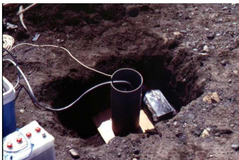
Figura 4.20. Instalación de un sensor de banda ancha durante la campaña 94-95.
