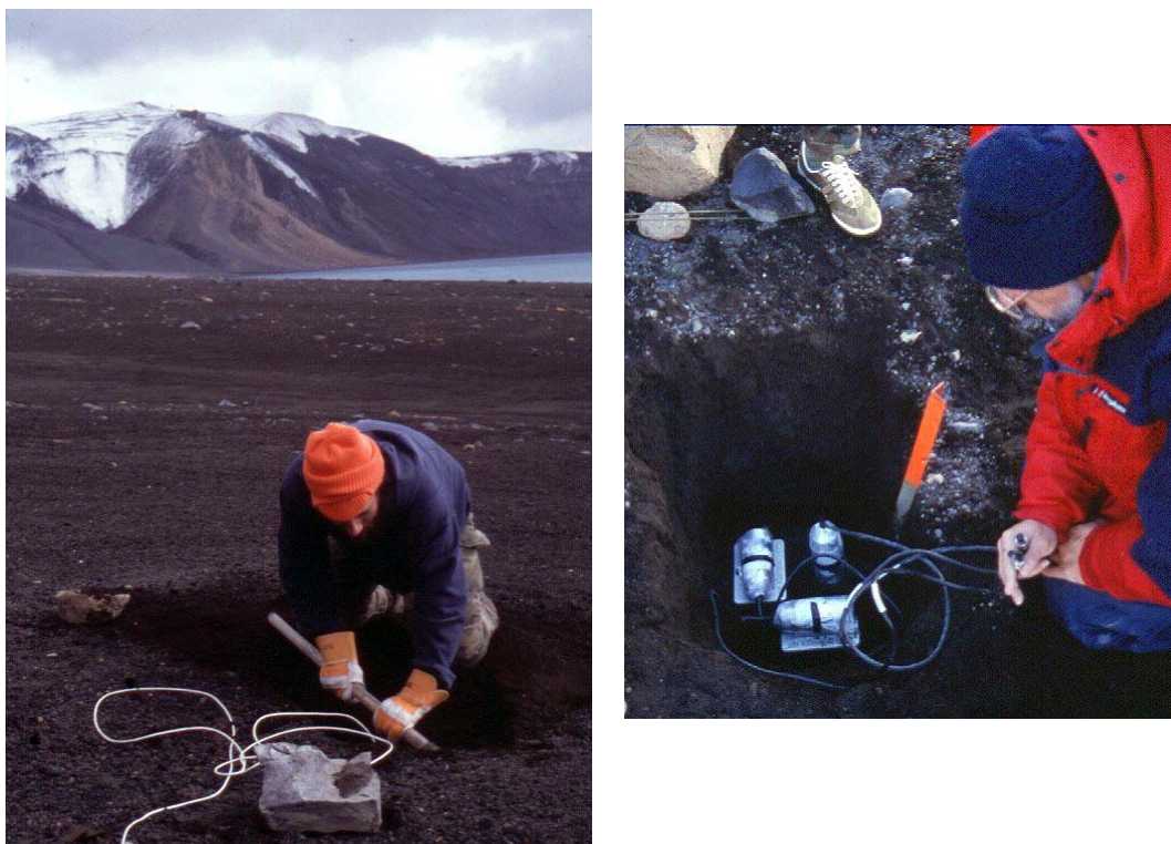
Figura 4.19. Instalación de los sismómetros en el array de la isla Decepción.
