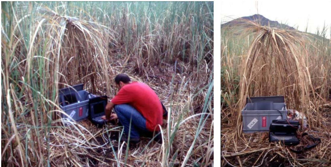
Figura 4.11. Centro de registro del módulo C en el array de Labronzo.
