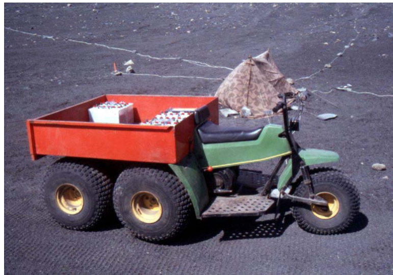
Figura 4.23. Moto de arena para el transporte de material.
