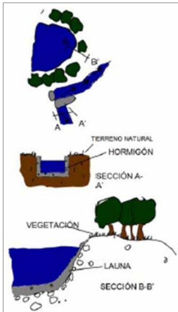
Ilustración 14. Planta y sección de una alberca tradicional. Elaboración propia.
