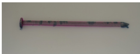
Fig. 4. Aspecto de un clavo metálico en el que se inicia el proceso corrosivo
