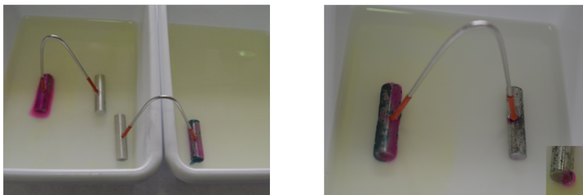
Fig. 7. Pares galvánicos para la protección del acero
