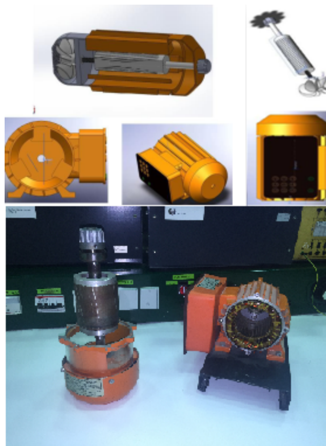
Figura 2. Diseño en Solidworks (arriba) de un motor eléctrico asíncrono y su homólogo real (abajo) desmontado donde se puede distinguir el rotor de jaula de ardilla y el estator.
