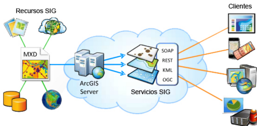
Figura 1. Esquema de funcionamiento de un servidor SIG (ArcGIS Server).
