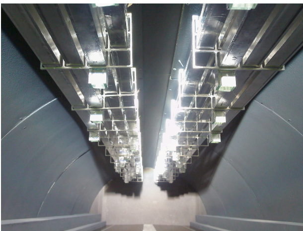
Figura 3. Fotografía del modelo a escala de lumiductos y sección transversal de la maqueta.
