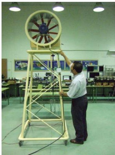
Figura 3. Dispositivo experimental empleado en la sesión de laboratorio dedicada a energía eólica.
