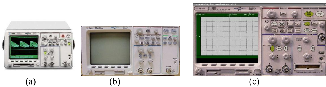
Figura 1. Osciloscopio real del laboratorio (a y b) y simulado del laboratorio virtual (c).
