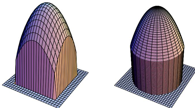
El valor de integral doble  $\iint_A f(x,y) d(x,y)$  nos da el volumen de dicho cilindro. Naturalmente, pueden darse otras muchas interpretaciones. Por ejemplo, la función  $f$  puede representar una densidad superficial de masa o de carga eléctrica en una lámina plana  $A$ . En tal caso la integral doble proporciona, respectivamente, la masa o la carga total de la lámina  $A$ .
