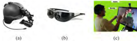
Fig. 1. Tecnología empleada en Realidad Aumentada. En (a) se muestra un modelo de sistema de seguimiento HMD ( Head Mounted Display ); en (b) un modelo de gafas de visión aumentada; en (c) se advierte un PC con cámara web y marcadores posicionales.
